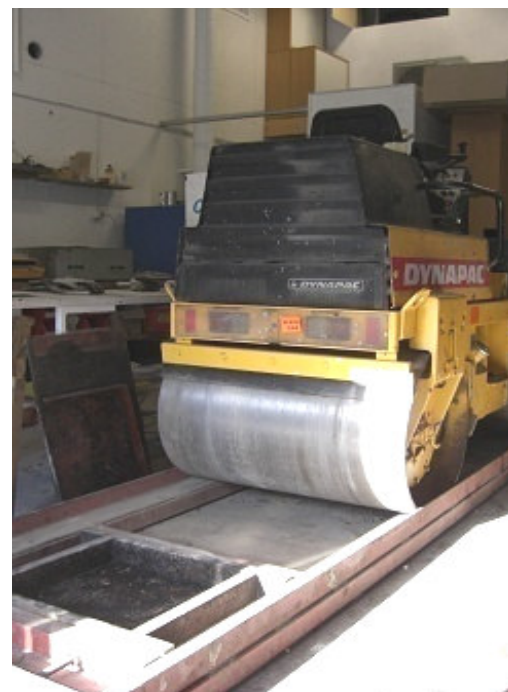
Bild 2. Packningsutrustning för tillverkning av provplattor enligt SS-EN 12697-33
