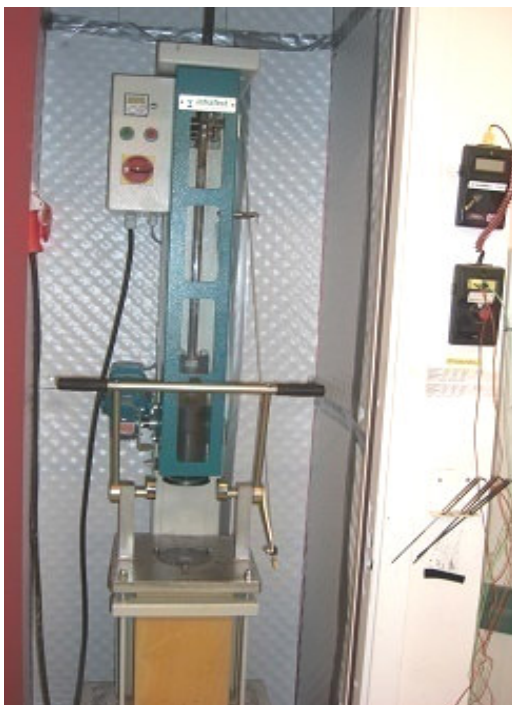
Bild 1. Marshall utrustning för packning av provkroppar, utrustningen uppfyller kravet på både FAS 414 och SS-En 12697-
